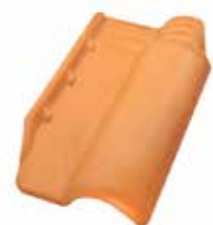
Telha Portuguesa 17 pçs por m 2 Inclinação Mínima: 35%
