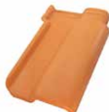
Telha Romana 16 pçs por m 2 Inclinação Mínima: 35%
